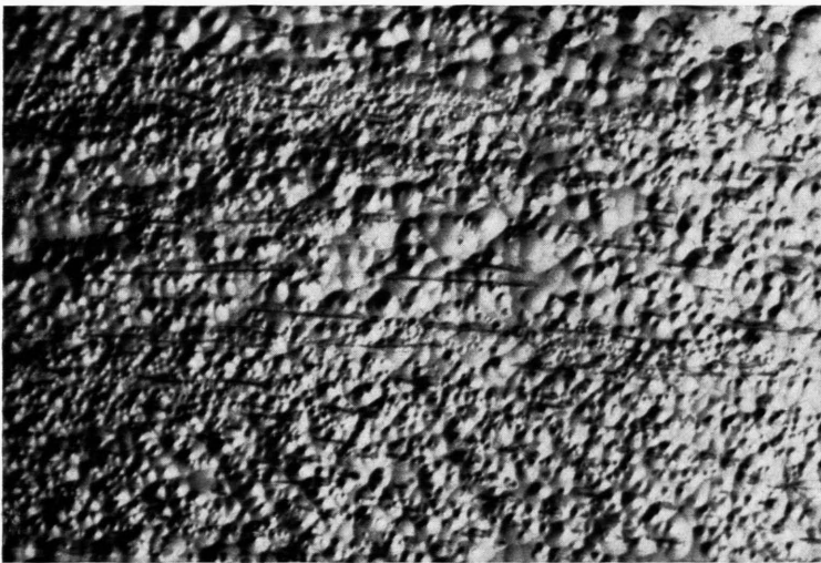
Abb. 11. In CP4 geätzte In{111}-Matrixfläche des Eutektikums; zahlreiche Ätzgruben und NiSb-Nadeln parallel der längeren Bildkante; 500-mal.
