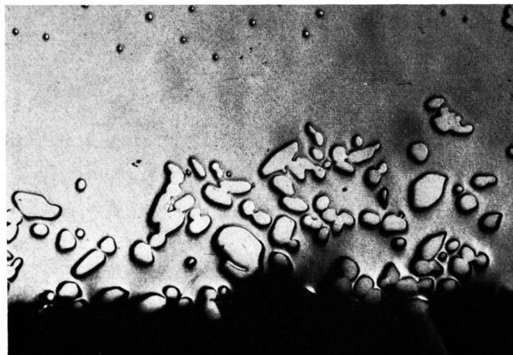
Abb. 8. Geringe Entmischung des Eutektikums bei langsamer Kristallisation ( v=0,01 mm/min). Grobe NiSb-Kristallite an der Unterseite des Barrens durch eine schmale Zone von InSb vom eutektischen Gefüge getrennt; Schnitt senkrecht zur Kristallisationsrichtung; 200-mal.
